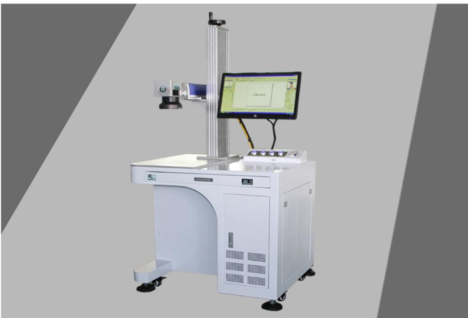
La máquina de marcado láser de fibra utilizan rayos láser de 1064nm para marcar superficies, principalmente metálicas, de forma permanente. El efecto de marcar consiste en revelar el material profundo a través de la evaporación del material de la superficie, o coloquialmente "quemar" la superficie causando el cambio físico y químico del material, mostrando el grabado requerido.
